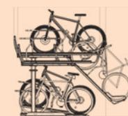
Voraussetzung: Durchgangshöhe der Überdachung anheben auf 2700 mm. Die Verwendung von ORION-Doppelstockparkern ermöglicht die Unterbringung der maximalen Anzahl an Rädern unter vorhandener Dachfläche! Infos zum Doppelstockparker finden Sie auf Seite 614.
