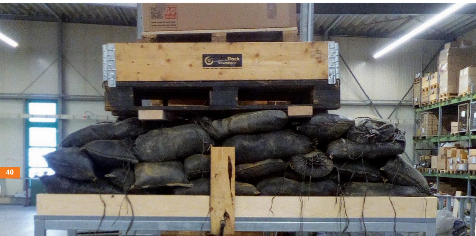
Die Belastung des Daches der Fahrradbox ARETUS erfolgte langsam und gleichmäßig. Bei einem Gewicht von 501,0 kg wurde eine elastische Verformung des Längsrahmens von ca. 2 mm gemessen. Das entspricht einer Belastung von ca. 294 kg/m<sup>2</sup>.
