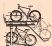
Voraussetzung: Durchgangshöhe der Überdachung anheben auf ca. 2700 mm. Die Verwendung von ORION-Doppelstockparkern ermöglicht die Unterbringung der maximalen Anzahl an Rädern unter vorhandener Dachfläche! Infos zum Doppelstockparker finden Sie auf Seite 614.
