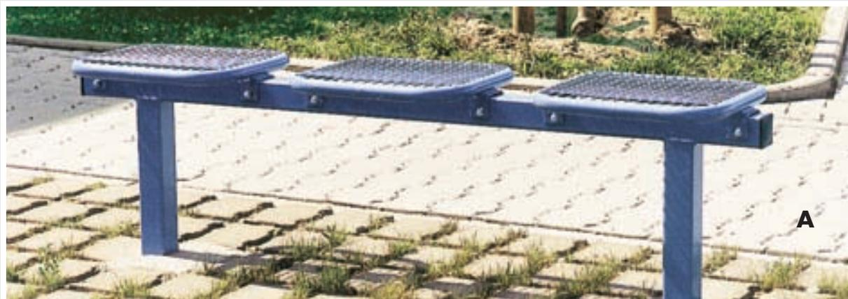
**A, C, D, E** Sitzen auf kunststoffüberzogenem Stahl. Angenehm warm und zugleich langlebig. Die freistehende, stabile Stahlkonstruktion sowie die aufgeschweißte Drahtgitter-Sitzfläche werden zum Schutz gegen Witterungseinflüsse grundsätzlich feuerverzinkt nach DIN EN ISO 1461 und zusätzlich pulverbeschichtet im **Farbton nach RAL**. Das Angebot an Sitzfläche reicht für 2 - 5 Personen, wobei Einzelsitze mit und ohne Rückenlehne genauso selbstverständlich sind, wie eine durchgehende Sitzfläche.
